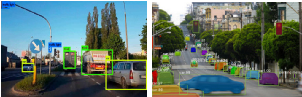
а) б) Рис. 3. Розпізнавання рухомих об'єктів з виділенням контура
