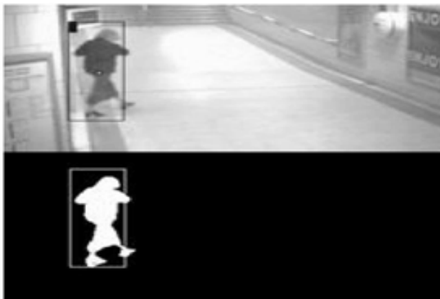
Рис. 1. Приклад віднімання фону в разі виявлення руху
